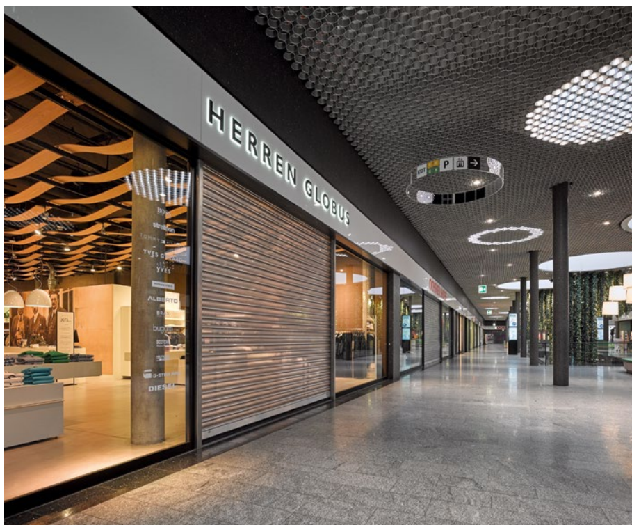
Den platsbesparande konstruktionen med hög driftsäkerhet i alla situationer, t ex. nödöppning utifrån, är en speciellt bra lösning för butiksöppningar utan separat ingång .
