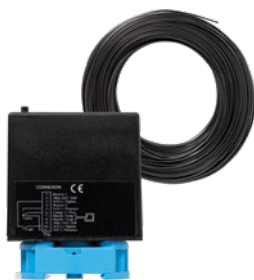
Induktionsslinga Induktionsdetektor med en brytande och en växlande kontakt, kan ställas in på impulsgivning eller permanentkontakt, riktning identifiering, 50 m slingkabel
